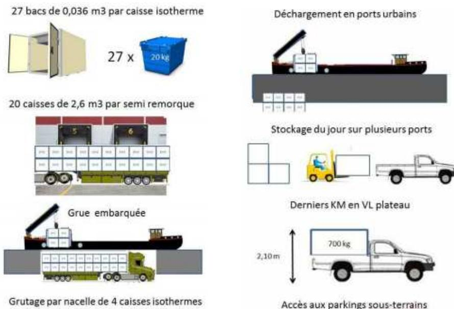
Le projet LUDAP vise à tester la livraison alimentaire (frais, surgelés, chaud) en caisses isothermes de 3 ou 10m<sup>3</sup> multimodales fluviaux-routier. Ces caisses disposent de 24 heures d'inertie thermique.
