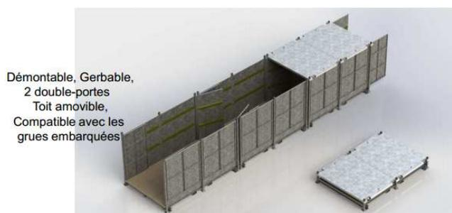
Une petite innovation technique va déboucher sur un grand nombre d'innovations de service : un conteneur (caisse multimodale) contenant de 20 m<sup>3</sup> qui dispose de doubles portes, d'un toit amovible (permettant le chargement par le haut) et entièrement démontable (il prend 20% de son encombrement une fois plié). Le conteneur est gerbable (superposable) par deux notamment pour l'optimisation du fret fluvial (deux couches en fonds de cale...).
