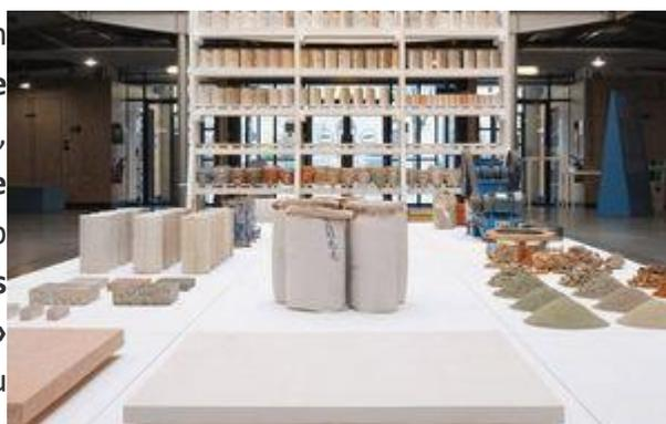
en **plâtre** questionnent une pratique contemporaine de la construction : Pour fabriquer des **chapes** ou des **plaques**, le **plâtre** est aussi **liant de très bonne qualité** lorsqu'il est mélangé à des **gravats de briques, tuiles ou béton concassés**, en remplacement du **sable et gravier** dont les ressources s'épuisent. [Article \(urba2000.com\)](https://www.urba2000.com)
